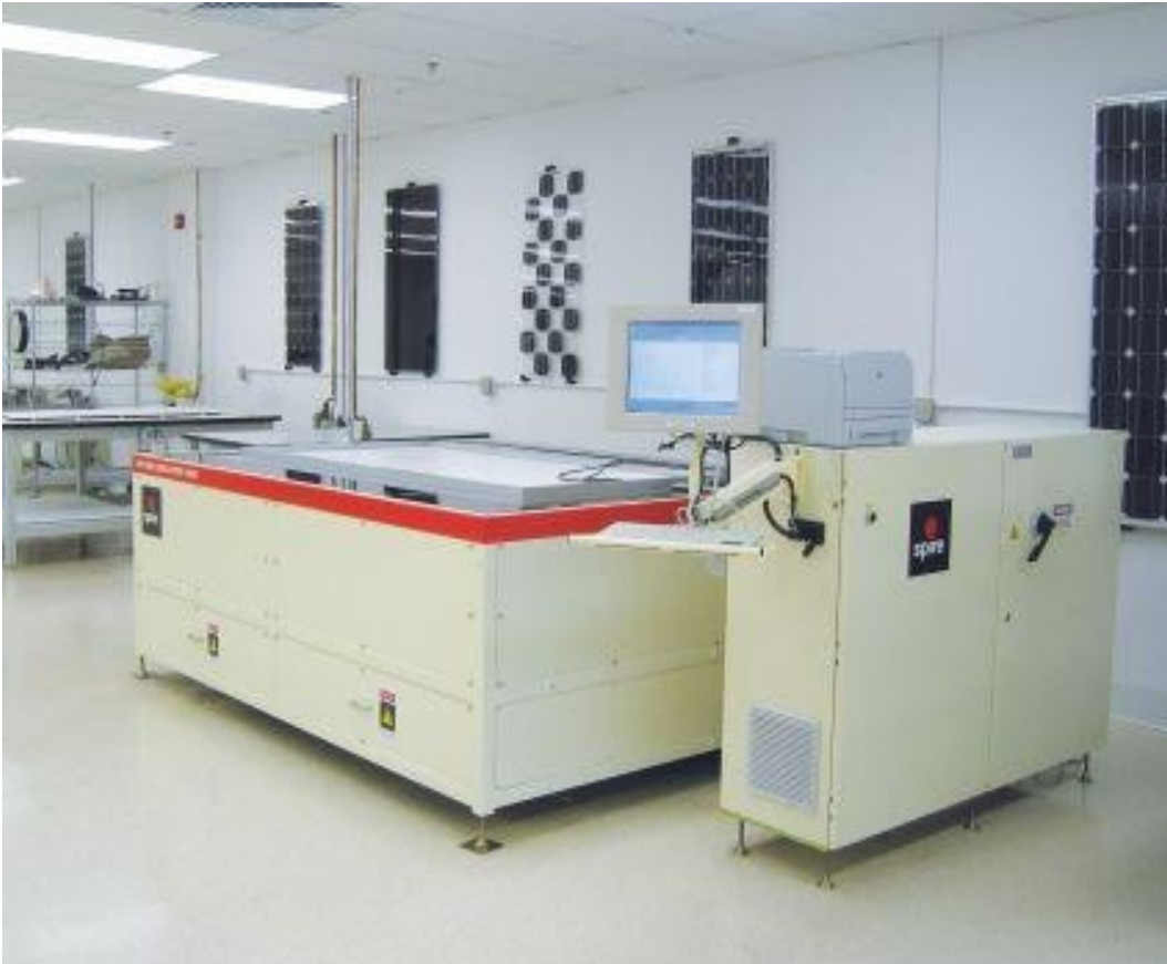
Banc de Flashage PV
